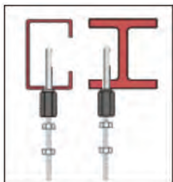
H形鋼・C形鋼に 吊りボルト取り付け
